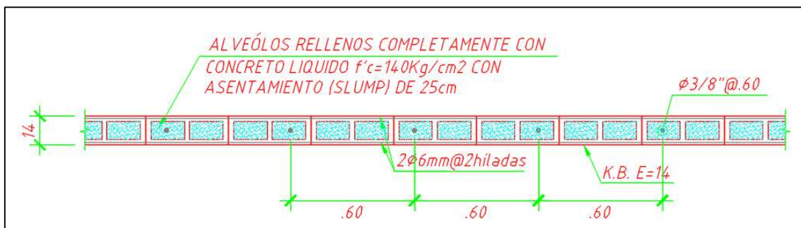
Figura 3.19 – Sección de tabiquería armada.
