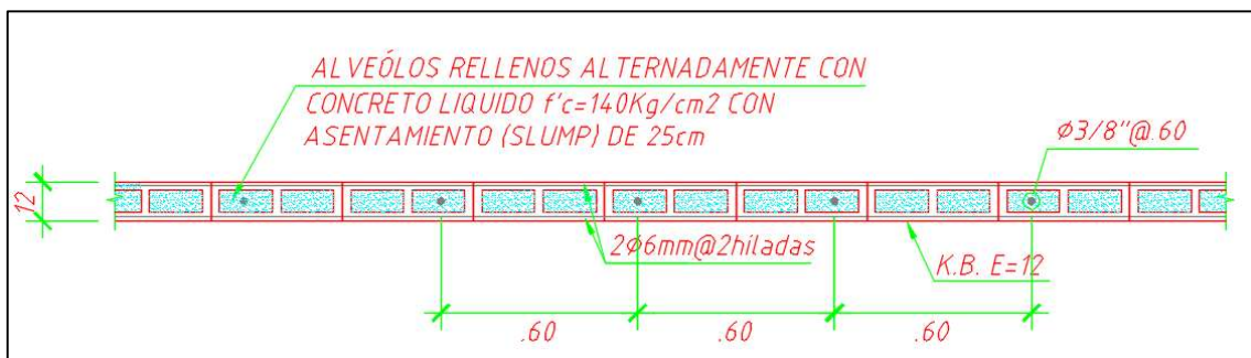
Figura 3.19 – Sección de tabiquería armada.
