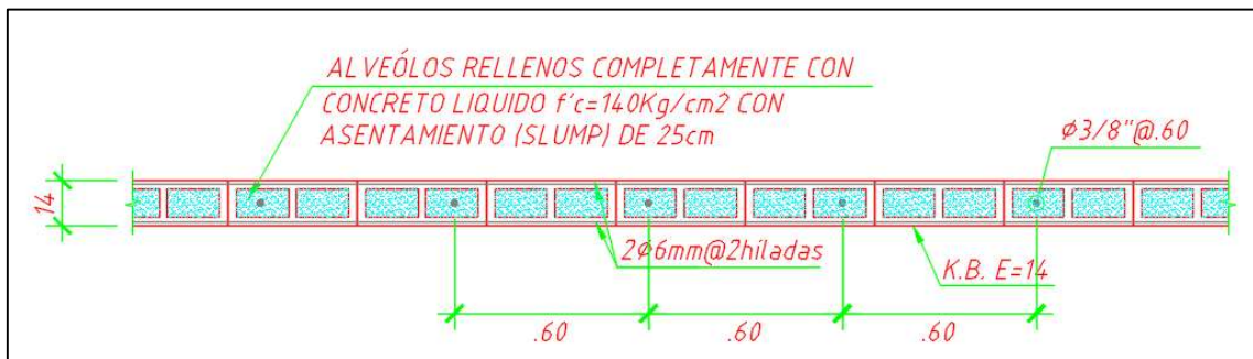
Figura 3.7 – Sección de tabiquería armada.
