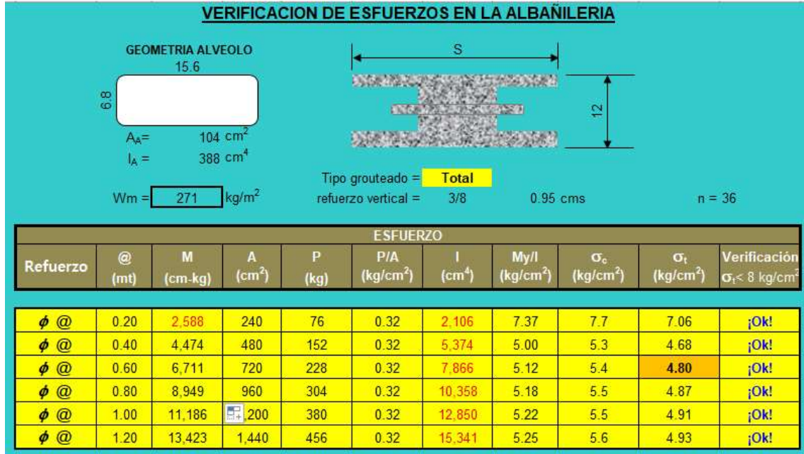
Figura 3.6 – Verificación de esfuerzo en tabiquería.
