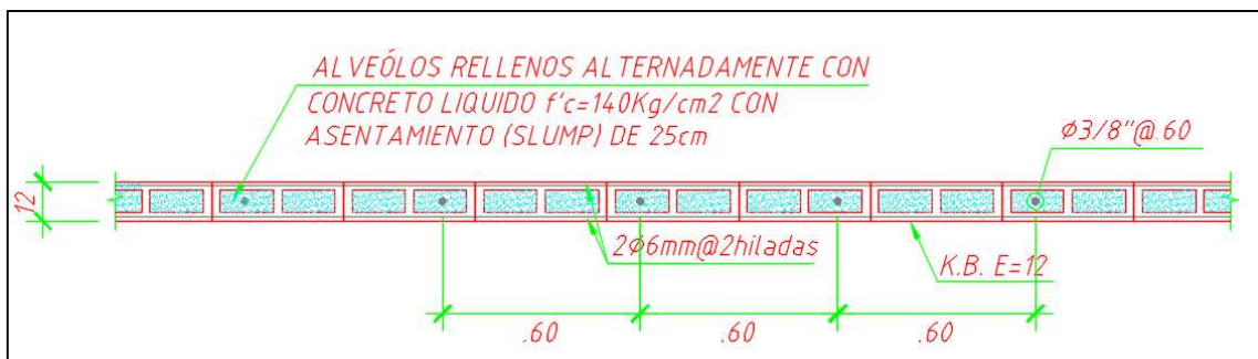
Figura 3.7 – Sección de tabiquería armada.
