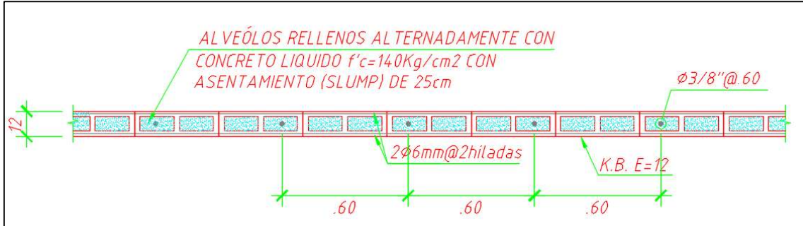
Figura 3.9 – Sección de tabiquería armada.
