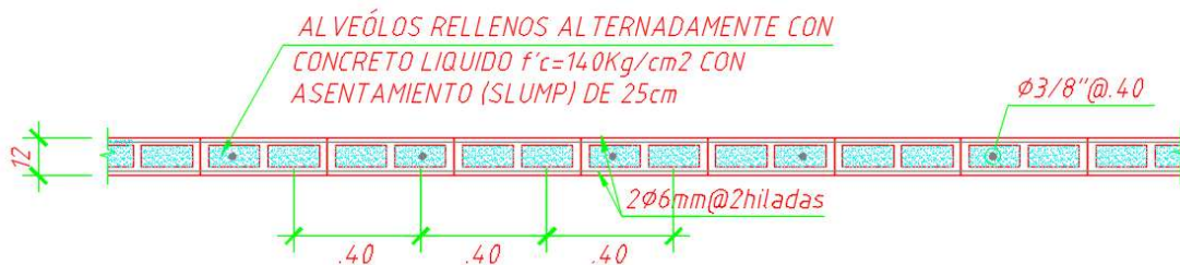
Figura 3.25 – Sección de tabiquería armada.
