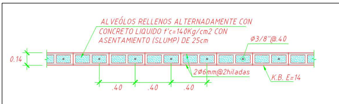
Figura 3.25 – Sección de tabiquería armada.
