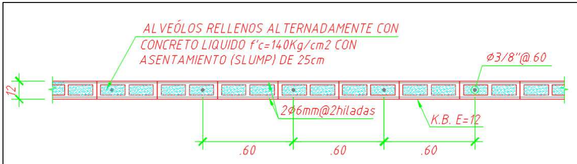
Figura 3.14 – Sección de tabiquería armada.
