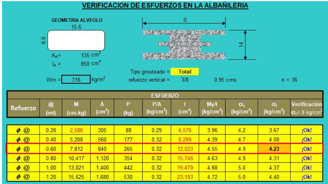
Figura 3.6 – Verificación de esfuerzo en tabiquería.
