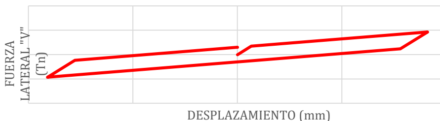
Figura 3.2.2 “Comportamiento bilineal de un aislador sísmico”
